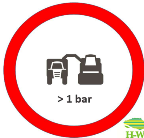
Afb. 2 HWodKa streeft naar een bandspanning van max. 1 bar bij oogstwerkzaamheden, met behoud van de oogstcapaciteit.
